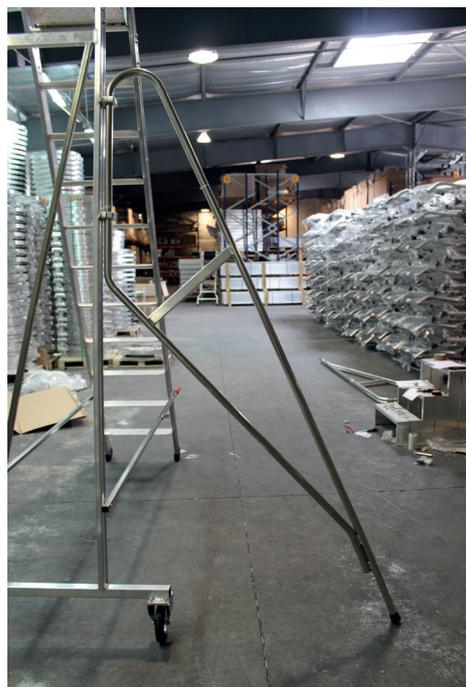
Placer le stabilisateur dans les deux fourreaux et y insérer les rondelles puis les serrer en laissant un peu de jeu pour pouvoir tourner le stabilisateur.
